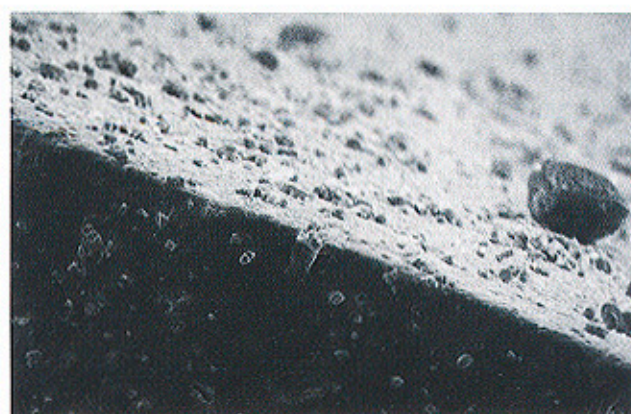
図-12 他種パーフロロエラストマー（充てん剤：無機系物質） プラズマ照射部の断面及び表面 ×1000
